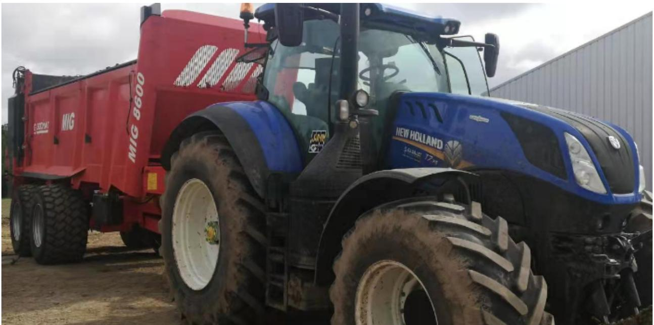
在农牧业行业中，通常要对牲畜的食物进行严格的控制管理。这就离不开一个机器叫TMR。TMR车的结构组成：搅拌车，会有一个漏斗形的料槽，按饲养配方将粗料，精料，矿物质和微生物充分混合，搅拌加入料槽。底部会装有测量重量信号的称重传感器。主要控制器，在TMR中装入此部件，主要接收底部称重传感器的重量信息和电脑存储的物料信息，以便于对装料，撒料进行控制。辅助控制器，这个部件安装于TMR车的装料点和铲车点，接收来自于主要控制器和电脑数据的连接，以便于提示铲车员，当前原料信息及重量。称重传感器，在饲料搅拌机底部安装TMR称重传感器，用于汇集物料信息，以便于物料人员增加物料。上海福滴采用的是意大利进口轴销式传感器，精度高，承载能力强，不易损坏。徐州直销称重系统厂家供应福滴称重系统在欧洲已经做了很多年，经验丰富。大部分应用场景，都有解决方案。
